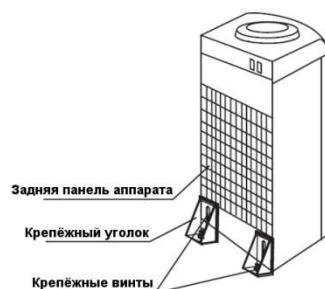
2. На задней панели аппарата в нижнем правом и левом углу извлеките крепёжные винты с помощью отвертки. Затем приложите крепежные уголки и закрепите их винтом на аппарате, как показано на рисунке 2 (1-3).
